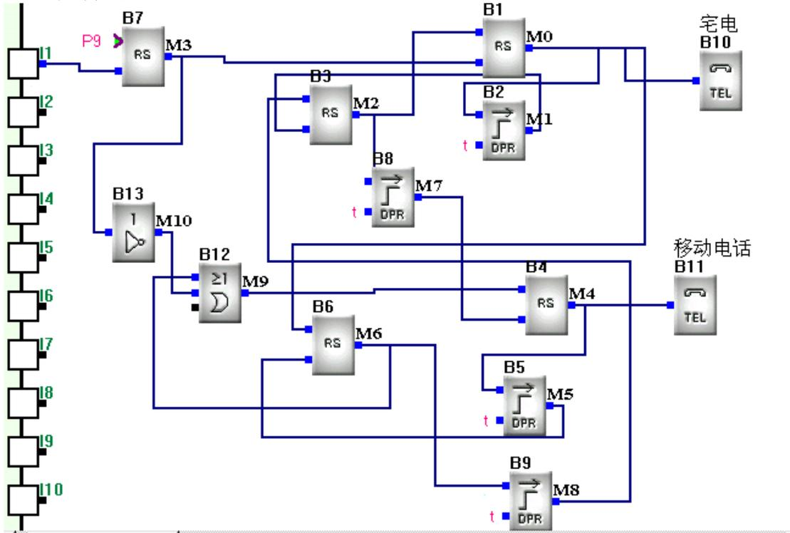
(2) 探头感应有人进入房间,开始通过B10拨打“宅电”电话。模拟如下：
