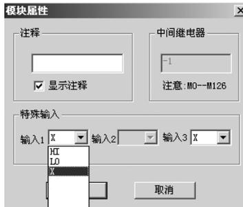
图 3.17 RS 继电器模块属性的设置
