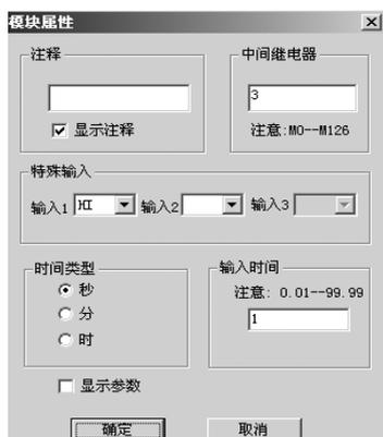
图 3.15 带有定时器的模块属性设置
