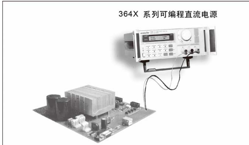
图2-1 364X 系列电源与负载的连接示意图
